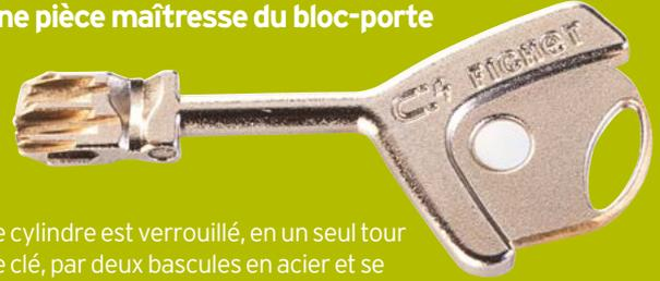
Le cylindre est verrouillé, en un seul tour de clé, par deux bascules en acier et se déverrouille grâce à ses deux aimants situés en bout de clé. Ses garnitures intérieures sont conçues pour empêcher toutes tentatives d'ouverture par crocheting. Une protection en acier traité vient renforcer sa haute résistance aux attaques par sciage, perçage et arrachement.
